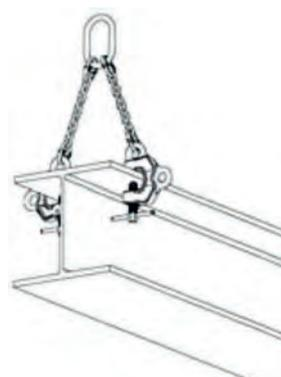
**KF-Hebezange / Larsenzange** (EN 13155)
