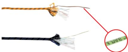
Jedes Spanset®-Seil wird neben dem Herstellungsjahr zusätzlich mit einer eindeutigen Seriennummer gekennzeichnet, dadurch wird die Rückverfolgbarkeit jedes Seils gewährleistet. Im Innern unserer Seile zeigt ein farbiger Kennfaden die EN-Nummer sowie den Typ des jeweiligen Seils.
