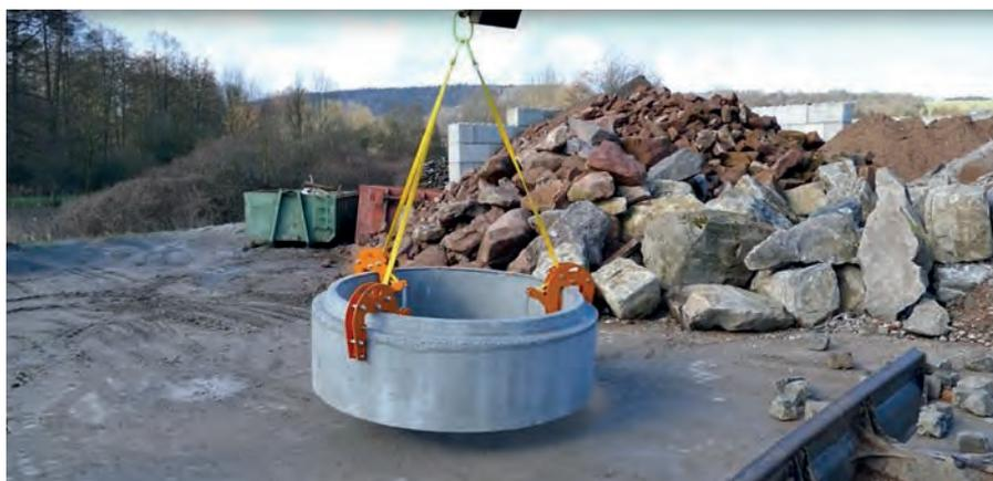
**Betonrohrgehänge mit Kette**
