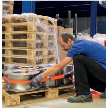
**25mm-Umreifungsgurt mit Spannbügel** (EN12195-2)
