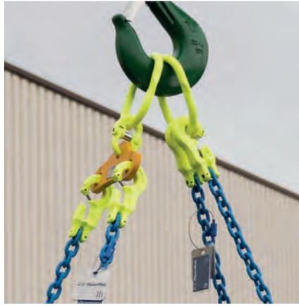
**Tragkraftoptimierung mit der Axzion – Ausgleichswippe für Anschlagketten**
