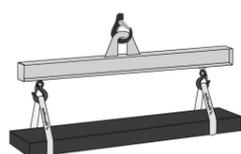
Werden Hebebänder paarweise eingesetzt, empfiehlt sich der Einsatz einer Traverse, damit die Last sich gleichmäßig auf die Stränge verteilt.
