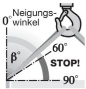
Hebebänder müssen so um die Last gelegt werden, dass sie mit der ganzen Seite tragen.
