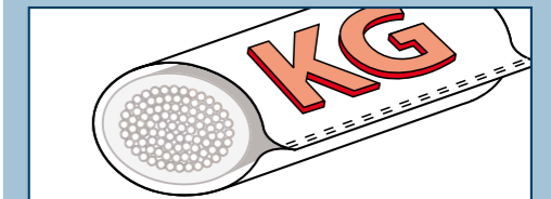
Tejido bordado en relieve- en especificación de capacidad de carga.
