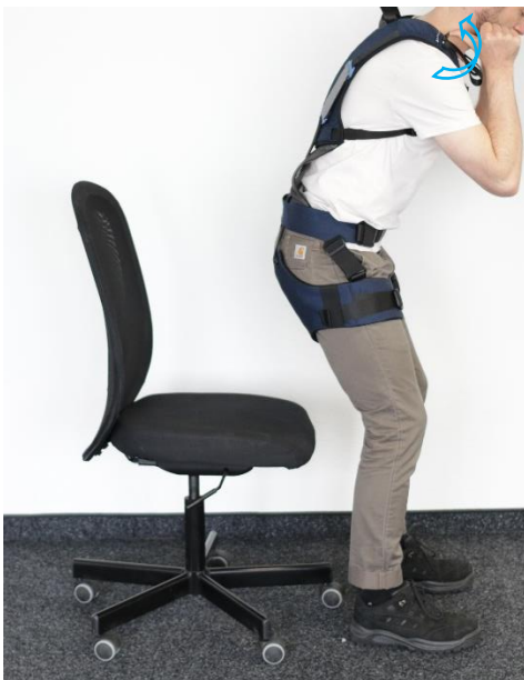
Quando ti siedi, dovresti disattivare il sistema. Basta inclinare le fibbie di attivazione verso l'alto mentre si è seduti.
