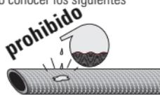
Las eslingas redondas Magnum-X, que entren en contacto con ácidos, lejías u otras sustancias agresivas, deben ser enjuagadas y lavadas antes de ser almacenadas o de volver a usarlas. Otros procedimientos de limpieza se los explica el comerciante especializado de SpanSet, o nosotros directamente. Las eslingas redondas Magnum-X con piezas metálicas no pueden ser usadas en condiciones ácidas, ya que se pierde la estabilidad.
