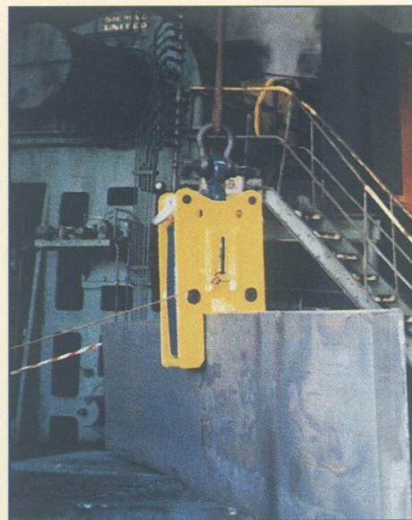
Zdalnie sterowany żaroodporny chwytnak do podnoszenia przeznaczony do zastosowania w zakresie temperatur do 1320° C IPSL
