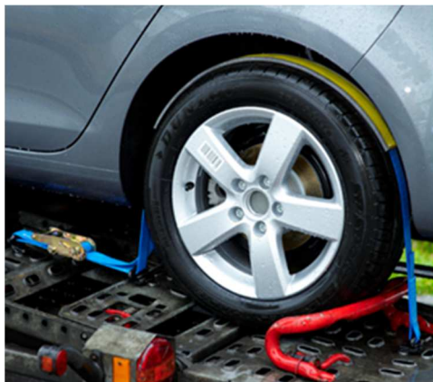
Abb. 2: Gute Kraftübertragung: Der gelbe Gurtcontroller sitzt fest auf dem Reifen, während der blaue Gurt beim Festzurren durch den „Schlauch“ rutscht.
