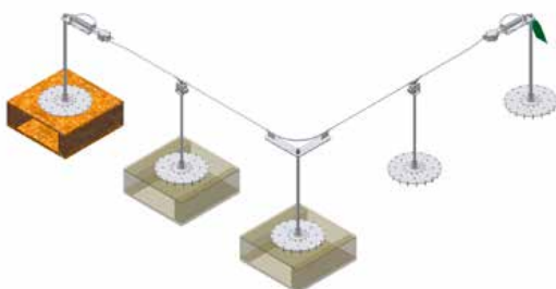
Seilsystem auf OSB/Rauschalung & Mehrschichtplatte
